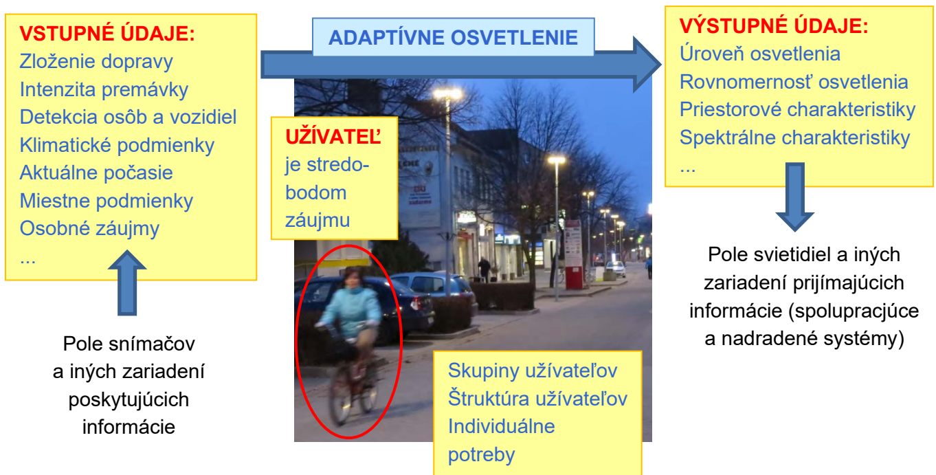
Obr. 2 Vstupno-výstupné vzťahy adaptívneho verejného osvetlenia
