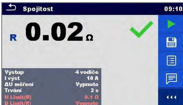
Obr. 6 – Ověření spojitosti PE obvodu
