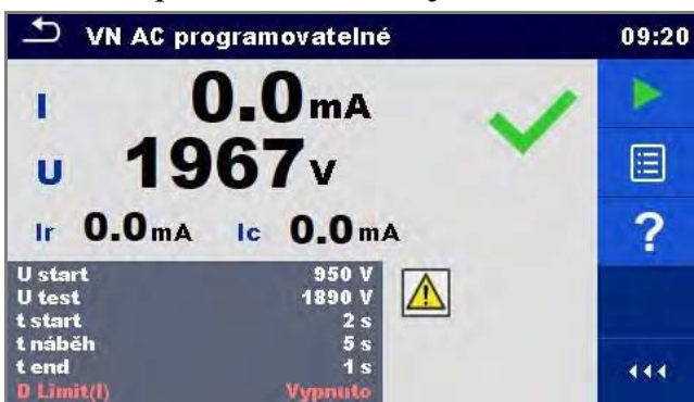
Obr. 7 – Měření impulzního výdržného napětí
