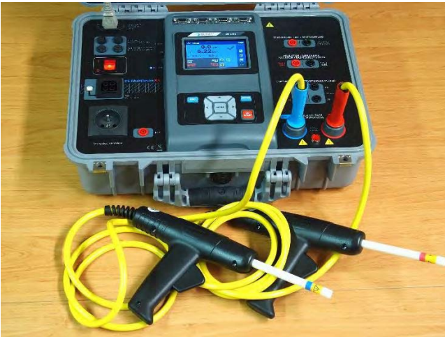
Obr. 8 – Sestava prístroje MI 3394 s VN měřicími hroty
