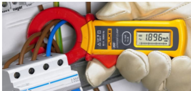
Obr. 2 Meranie unikajúceho prúdu rozdielovou metódou pomocou prúdových klieští
